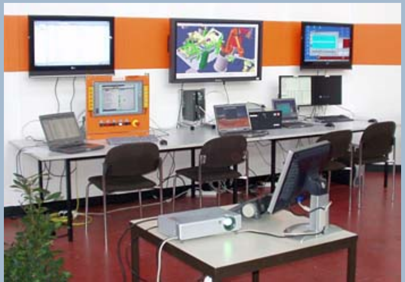
Der aktuelle Stand bei Kuka Systems umfasst ein Demonstrator-System mit Delmia Automation R19 SP3. Hier werden auch Untersuchungen zu einer Bibliothek für mechatronische Verhaltensmodelle durchgeführt. Deutlich zu sehen: Die Steuerungshardware in the Loop.
