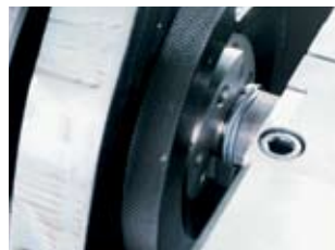
ВЫРУБКА НАПЛЫВОВ, ОБРАЗОВАННЫХ СВАРКОЙ ТРЕНИЕМ
