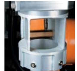
Cross-/Conejetfunktion zur Vermeidung von Linsenverschmutzung und Plasma am Schweißbad
