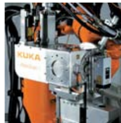
Plug & Play Abstandsensor zur direkten Übernahme der Abstandsinformation in das Roboterprogramm
