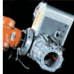
Einfaches Teachen durch zwei integrierte Programmpointer, welche sich im Fokus treffen
